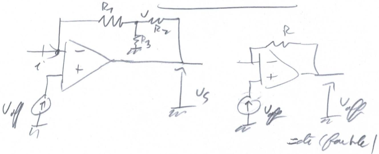
En superposition, on calcule la réponse à  $U_{off}$  quand  $i=0$
