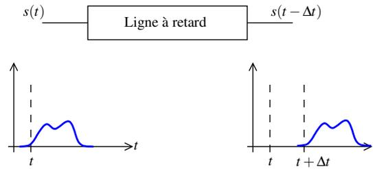
Une ligne à retard idéale n'existe pas. En général, il y a aussi atténuation du signal. Soit  $A_{ll}$  l'atténuation dans la ligne. On supposera que  $A_{ll}$  est un réel positif inférieur à 1. Le signal de sortie de la ligne à retard est donc plutôt de la forme  $s_{out}(t) = A_{ll} s(t - \Delta t)$ .
