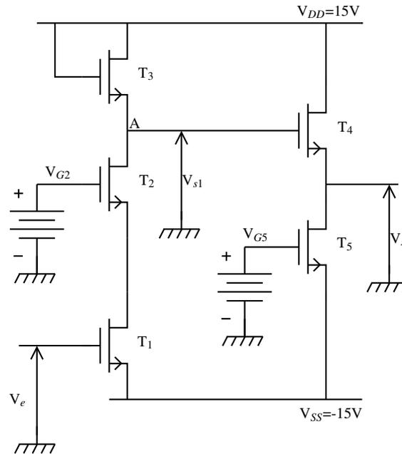
Les transistors  $T_1$ ,  $T_2$ ,  $T_4$  et  $T_5$  sont identiques. Pour le point de polarisation choisi, ils sont tels que  $g = \frac{\partial I_{DS}}{\partial V_{GS}} = 10 \text{ mS}$ .
