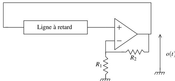
Cet oscillateur oscille linéairement, c'est-à-dire sans que l'AOP ne sature, s'il est juste instable (stabilité au sens strict). Dans ce cas, les oscillations sont purement sinusoïdales.
