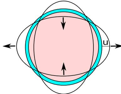
Lors de la vibration d'un verre rempli de fluide visqueux, le fluide contribue à la fois à l'inertie et à la dissipation visqueuse, qui ont l'effet respectivement de baisser la fréquence de résonance et de raccourcir la durée du son émis.
