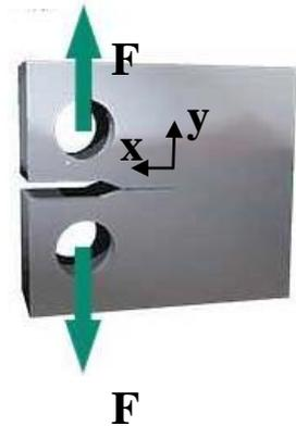
1) Déterminer en loi d'échelle la forme du profil d'ouverture  $Y = u_y(X)$  de la fissure (la fissure est initialement fermée, et  $u_y$  est le déplacement normale à la fissure associé au chargement) :
