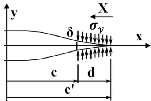
4) En faisant l'approximation que le profil d'ouverture de la fissure dans la zone extérieure à la zone plastique ( $X > d$ ) ne soit pas fortement altéré par la présence de la zone plastique, estimer l'ordre de grandeur de l'ouverture  $\delta$  à la fin de la zone plastique.
