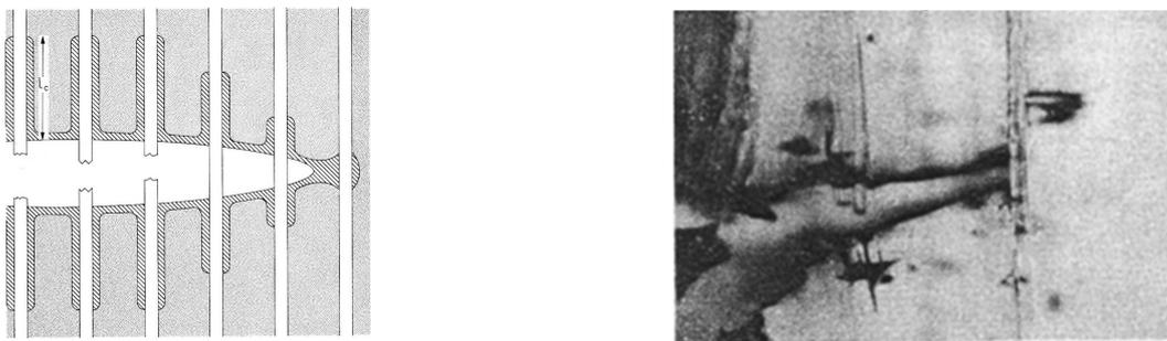
Figure 1: Schéma de l'action de renforcement des fibres lors de la propagation d'une fissure (gauche) et cliché expérimental de la pointe de fissure dans un composite.
