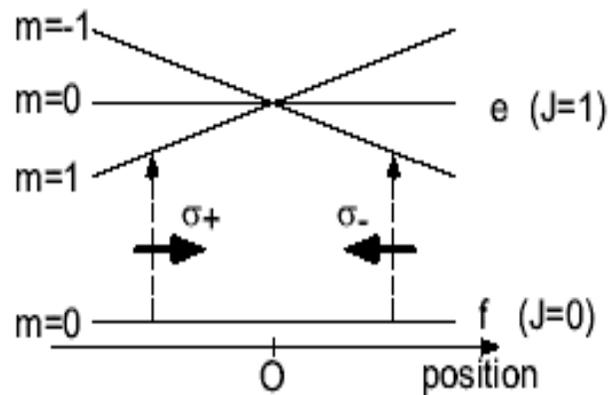
Principe du piège magnéto-optique :
