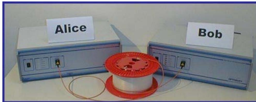
Dispositif commercial de cryptographie quantique
