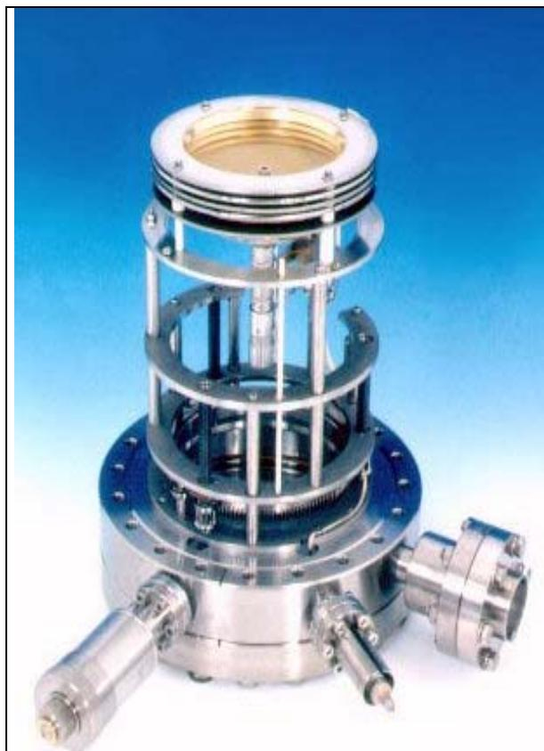
**Optique « quatre grilles » de diffraction d'électrons lents dispositif expérimental**
